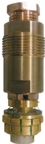
图 28 已安装好的电测量高压腔腔体
