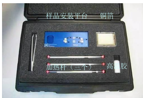
图 15 磁学高温测量样品安装组件
