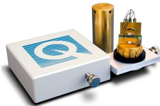
图 26 热输运样品安装平台
