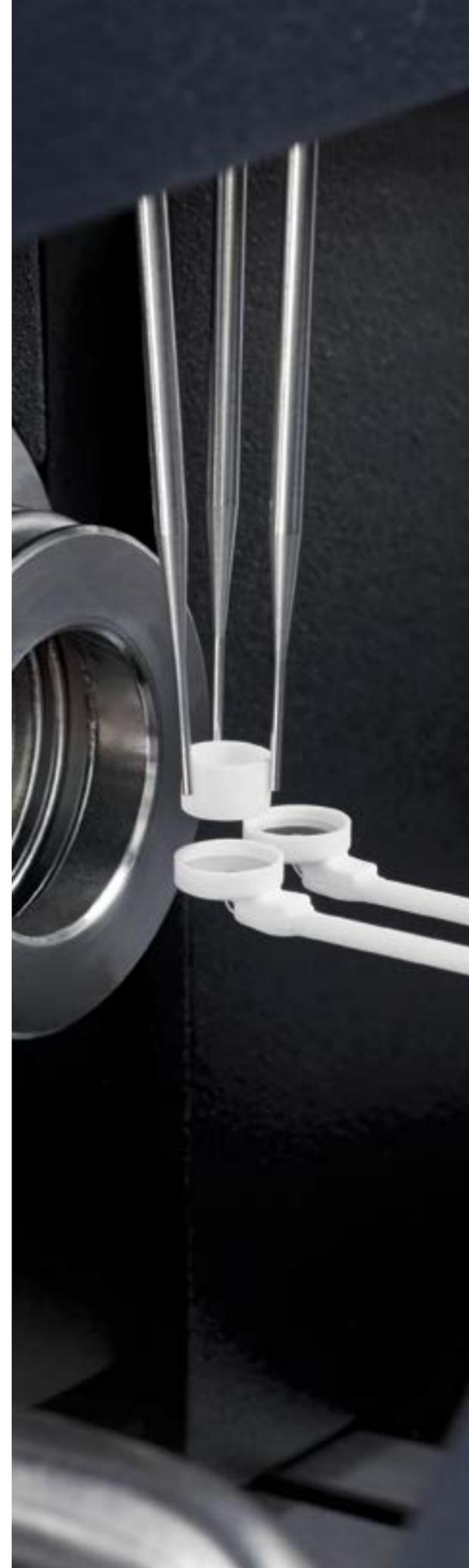
为了提高效率，全新Discovery SDT可配置30位自动样品进样器。它基于久经考验的Discovery DSC自动样品进样器设计而来，在TA工厂进行了高密度的循环测试验证，确保无忧运行。
