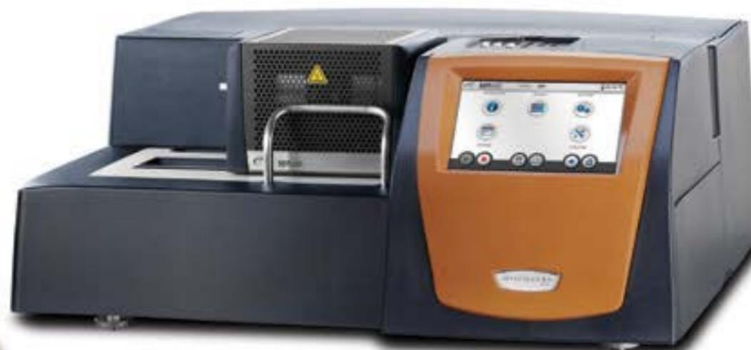
全新的Discovery SDT以TA专有的水平双臂热天平为核心。陶瓷支架中集成热电偶设计，可直接测量样品温度、参比温度及差温。这可确保DSC和TGA的性能达到最佳水平。与竞争对手的系统设计不同，SDT 650无需执行基线扣除及其他测试后处理操作。因此，Discovery SDT在重量漂移、灵敏度和同步DSC/TGA测量方面拥有无与伦比的优越性能。
